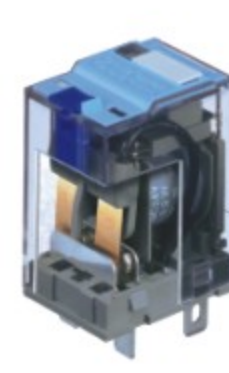
C7-W10... 抗高冲击电流型继电器，单极常开触点，并联型双触点 (分别为银触点和钨触点) 结构
